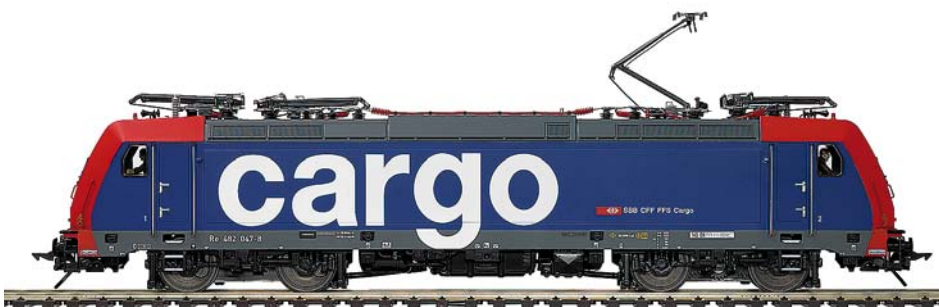
120 05632 2 Elektrolokomotive Serie Re 482 der SBB Cargo AG (Schweiz) Ausführung TRAXX F140 AC2
