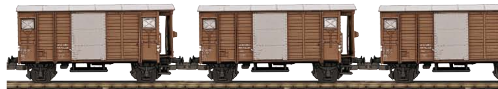
120 99016 0 Gedeckter Güterwagen K 2 der Schweizerischen Bundesbahnen Ausführung für Stückgut, Epoche III, Farbgebung: braun mit silbernen Türen («für Güter die Bahn»)
