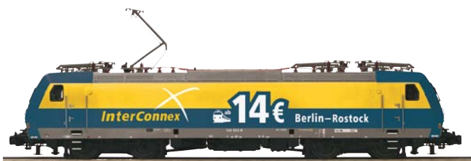
120 05633 2 Elektrolokomotive BR 146.5 der Veolia Verkehr GmbH (Deutschland); Ausführung TRAXX P160 AC2
