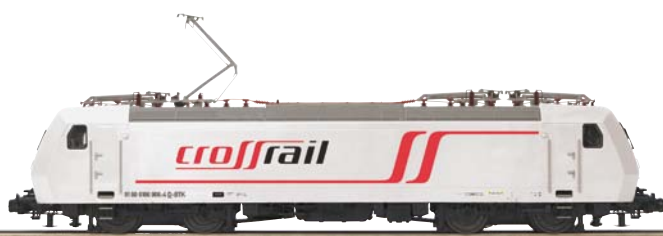
120 05648 2 Elektrolokomotive Serie Re 482 der Crossrail AG (Schweiz); Ausführung TRAXX F140 AC2
