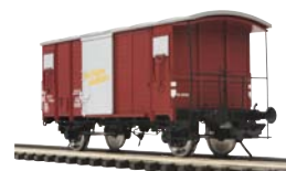
120 99016 0 Gedeckter Güterwagen K 2 der Schweizerischen Bundesbahnen Ausführung für Stückgut, Epoche III, Farbgebung: braun mit silbernen Türen («für Güter die Bahn»)
